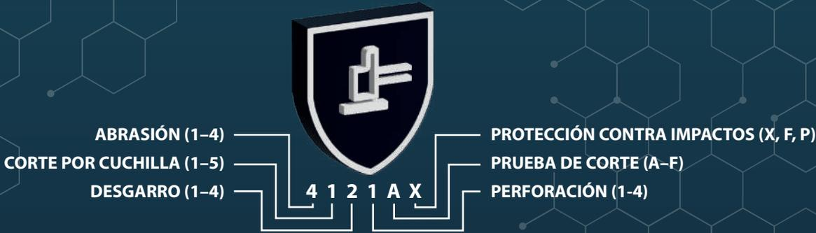
Esta norma es esencial para seleccionar el guante adecuado según los niveles de riesgo mecánico de cada tarea específica.
