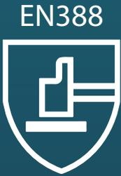
La norma EN 388 especifica los requisitos, métodos de ensayo y niveles de rendimiento para los guantes diseñados para proteger contra riesgos mecánicos. Evalúa la resistencia del material a la abrasión, corte por cuchilla, desgarró, perforación y, en las versiones más recientes, también el corte por cuchilla recta (ISO 13997) y la protección contra impactos.
